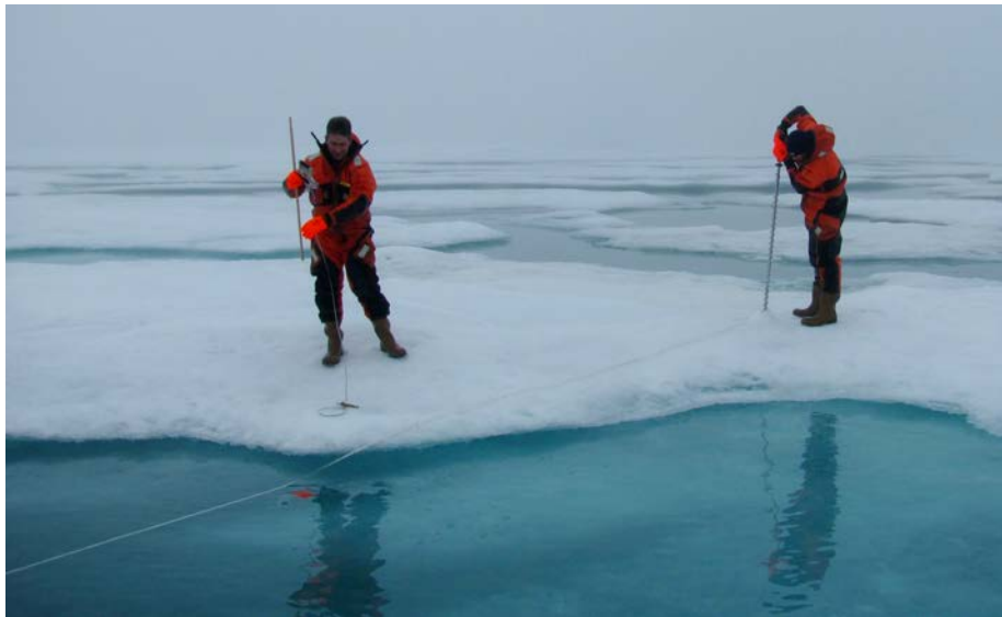
Abbildung 3.3: Vorbereitung und Markierung des Messprofiles, sowie Messung der Eisgeometrie entlang des Profiles auf der Station am 19. August
