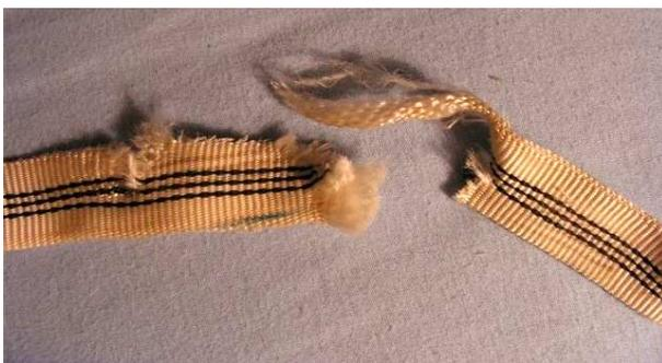
Typisches Rissbild bei Riss im Linelocker. Es ist gut zu erkennen, dass das Band an zwei Stellen abgequetscht wird
